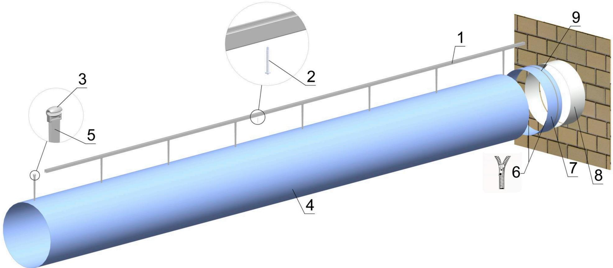
1 – алюминиевый рельс; 2 – крепежный элемент (саморез, дюбель-гвоздь); 3 – универсальное крепление-зацеп; 4 – воздуховод; 5 – тканевый подвес; 6 – застежка-молния; 7 – присоединение; 8 – выход установки; 9 – стальной ленточный хомут с замком
